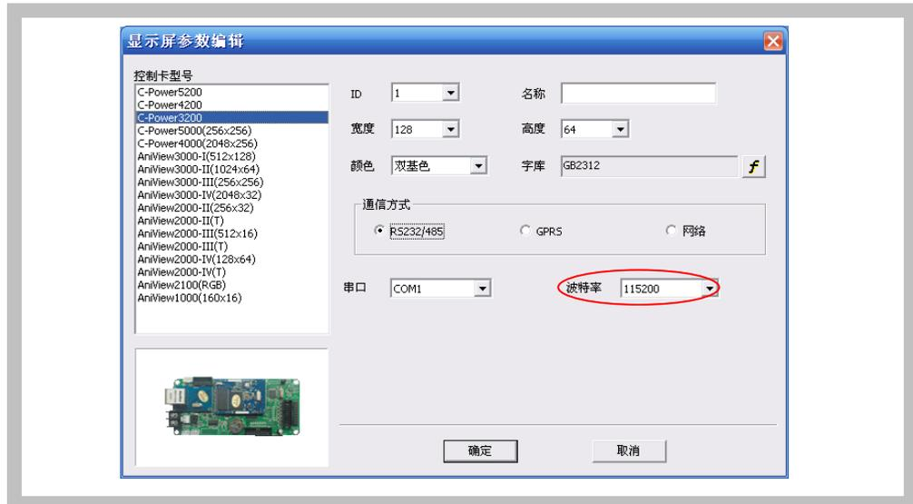
图13 串口方式下“显示屏参数编辑”对话框，
